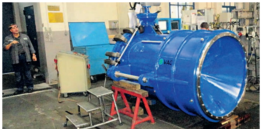
Kegelstrahlventil in der Fertigung
