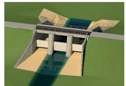
3-D-Darstellung Durchlassbauwerk im Normalzustand, aktueller Planungsstand
