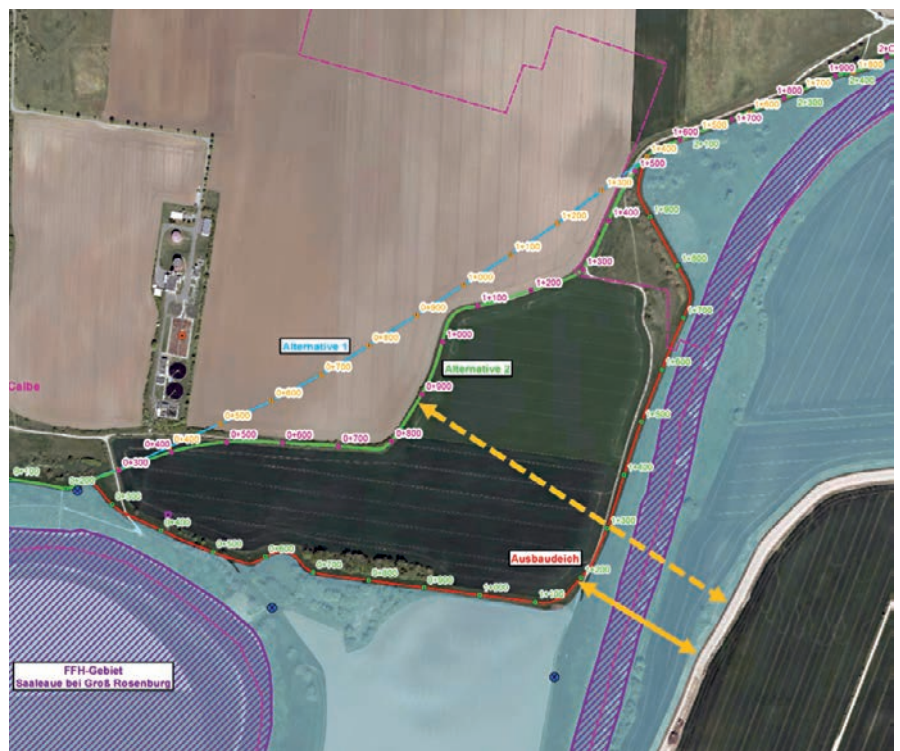
Trassenuntersuchung der geplanten Deichrückverlegung
