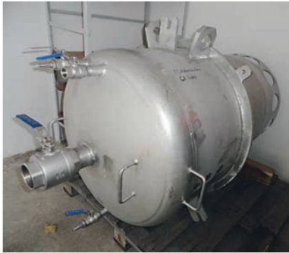
Einschwimmbarer Revisionsverschluss für den linken Grundablass
